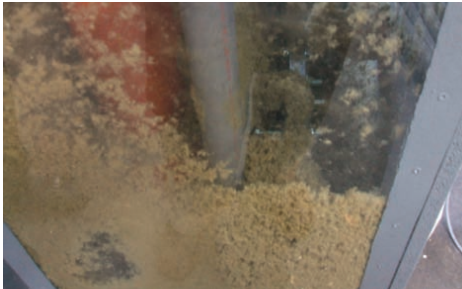
Granulat während der Einblasphase
